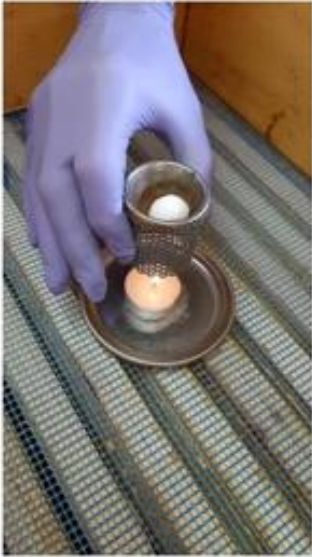
Einfacher Verdampfer mit Kerze
